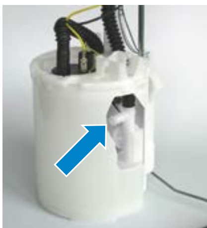
Fig. 1: Vista do interior do módulo de alimentação de combustível (recorte) com conexão cega
